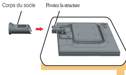
3. Insérez la Base du socle dans le Corps du socle dans la direction indiquée ci-dessous.
