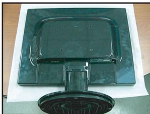
2. Séparez le socle à l'aide d'un tournevis comme montré dans le schéma.
